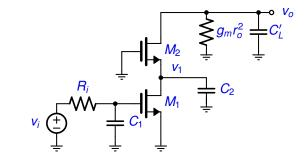
•  $C'_L = C_L + C_{db2} + C_{gd2}$
