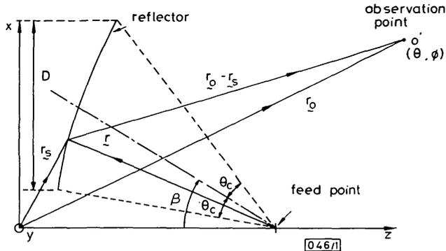
Fig. 1 Reflector geometry
