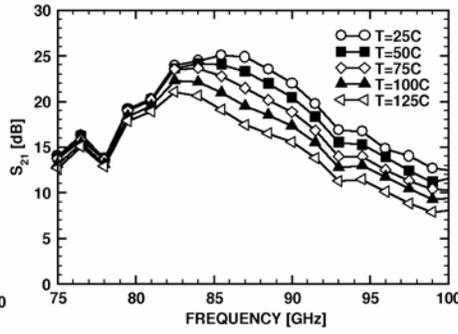
Fig. 11. LNA S<sub>21</sub> over temperature.
